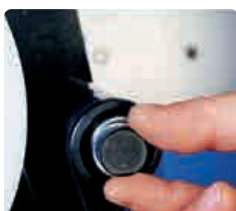
Einstellbare Folienspannung. Tensione regolabile del film. Регуляция натяжения пленки.
