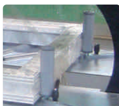
Seitliche Einmitter. Rulli centrotori laterali. Центрирующая система по краям.
